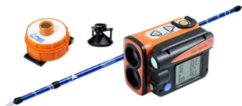
Mediciones de largo alcance con láser de alta precisión y sensores de brújula e inclinación integrados para mediciones 3D precisas. Los resultados se presentan en una pantalla de datos integrada y en una pantalla gráfica externa. Tamaño: 93x63x72mm/3.7x2.5x2.8" Peso: 243 g/8.6oz.
